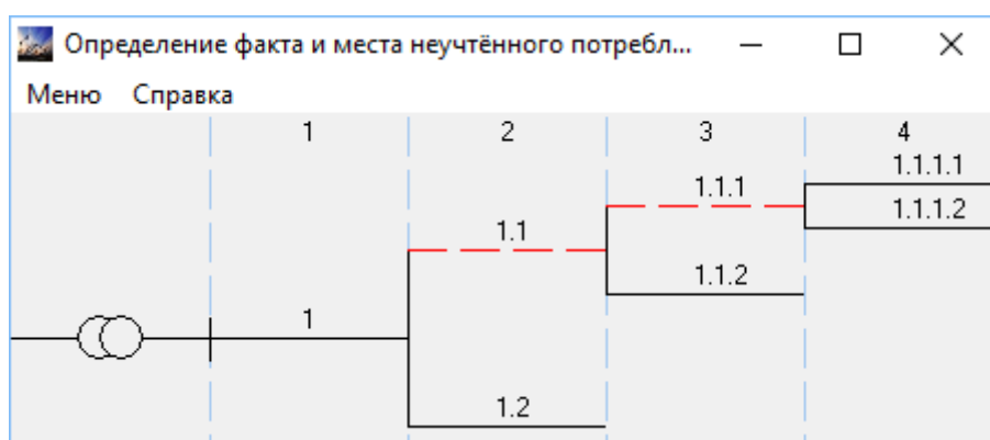
Рис. 4. Графическое представление рассматриваемой сети с указанными участками, имеющими повышенные технические потери
